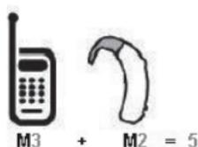
En el ejemplo antes señalado, si un aparato para sordera cumple con la clasificación de nivel M2 y el teléfono inalámbrico cumple la clasificación de nivel M3, la suma de los dos valores es igual a M5. Esto debería proporcionar al usuario del aparato para sordera un "uso normal" al usar su dispositivo auditivo con ese teléfono inalámbrico en particular. "Uso normal" en este contexto se define como una calidad de señal que es aceptable para el funcionamiento normal.
